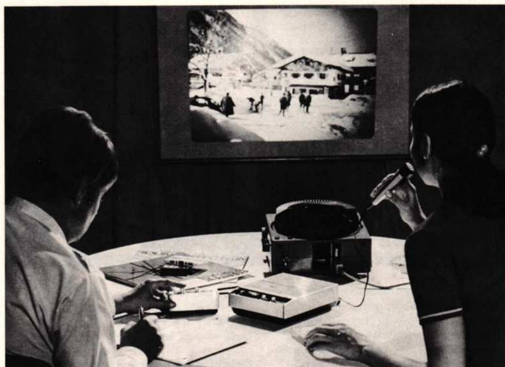
Afb. 3 Geluidsdiaprojectie met de cassette-recorder N2209AV automatic en stuurapparaat LFD-3442 (Philips).
