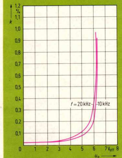
Fig. 7 Vervorming als functie van de ingangspanning bij frequenties van resp. 10 en 20 kHz.
