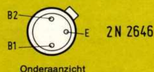
Fig. 3 Hoe de PUT moet worden aangesloten kunt u nu duidelijk zien. U kijkt onder tegen de transistor aan.
