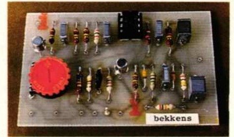
Afb. 12. Deze foto geeft een goede indruk van de montage van de print die de klank opwekt van de bekken.
