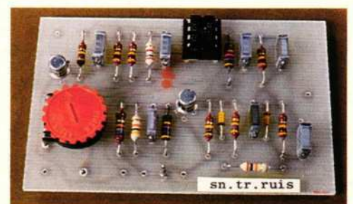
Afb. 10. Deze foto geeft de compleet gemonteerde ruisprint voor de snaartrommel.
