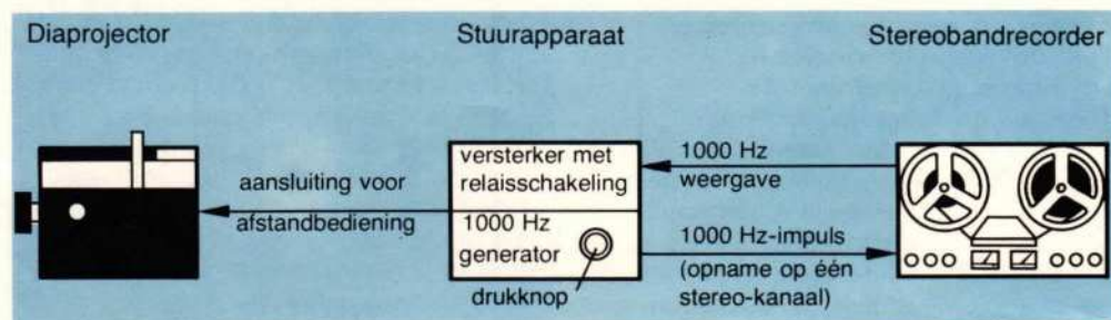
Fig. 2 Opstelling van een geluidsdiaprojectie met stuurapparaat en stereobandrecorder
