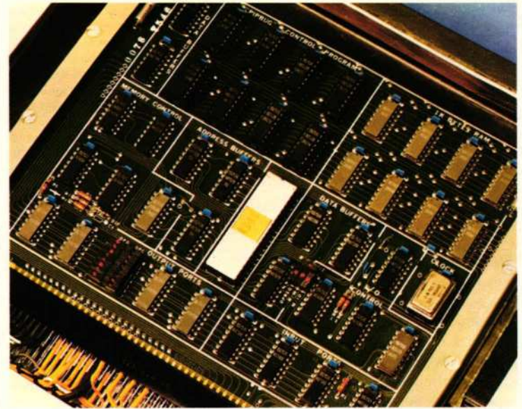
In het midden van de print, ziet u de 265° micro processor van Sigmetics (foto: Philips)
